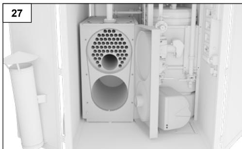
5. Entfernen Sie die Rauchgasinhibitoren.
