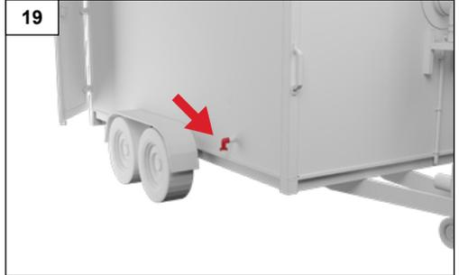
Verwenden Sie einen stabilen Schlauch, um den Wasserkocher aufzufüllen. Füllen Sie den Schlauch vor dem Anschließen so voll wie möglich mit Wasser. Entfernen Sie den Deckel vom Einfüllhahn. Schließen Sie dann den Schlauch an den Füllhahn an.
